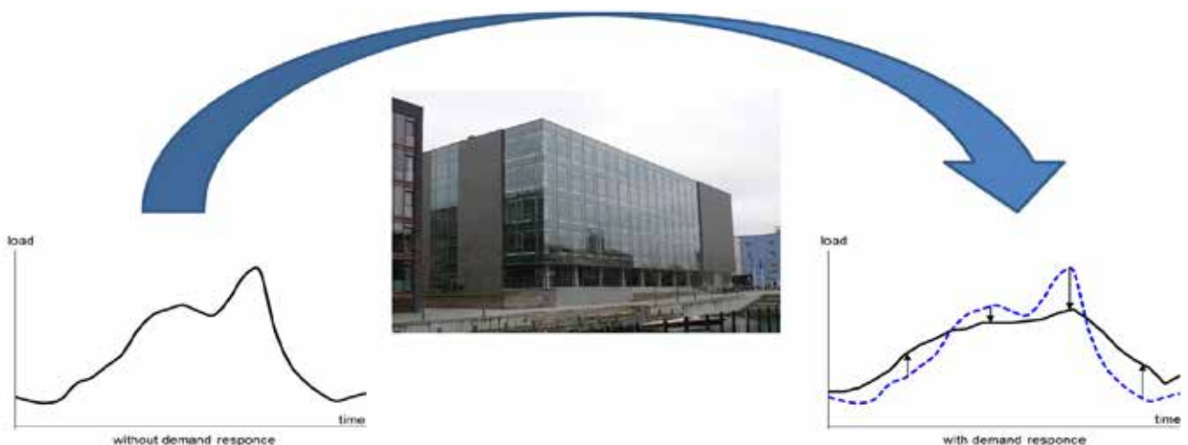
Figuur 1: VERSCHUIVING VAN DE VRAAG MET BEHULP VAN DE FLEXIBILITEIT VAN EEN GEBOUW EN ZIJN INSTALLATIES.
